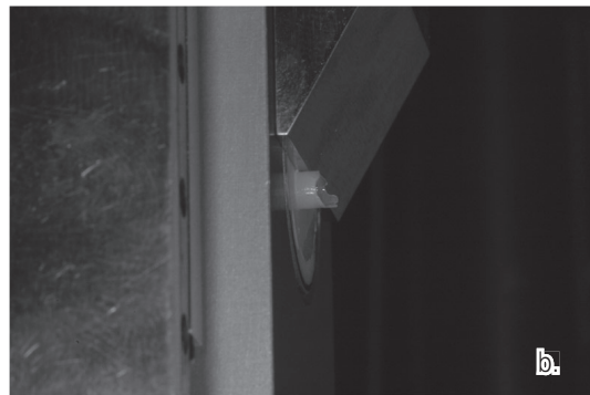
รูปที่ 4 a. แสดงแนวการทดสอบกำลังแรงยึดเฉือน b. แสดงการทดสอบกำลังแรงยึดเฉือนโดยใช้เครื่องทดสอบสากล
