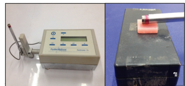
รูปที่ 2 การวัดค่าความหยาบผิวด้วยเครื่องทดสอบความหยาบผิวพรอไฟโลมิเตอร์
