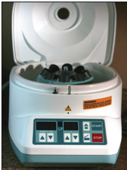
รูปที่ 1 เครื่องปั่นหมุน พีซี-02 (Process, Nice, France) ดัดแปลงจาก Michael และคณะ 2009
