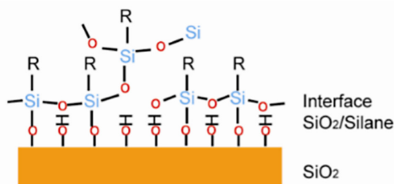
ภาพที่ 16 การเกิดพันธะไฮลอกเซนระหว่างสารคู่ควบไฮเลนกับกลุ่มไฮดรอกซิลบนพื้นผิวซิลิกา (27)
