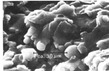
รูปที่ 48 ภาพถ่ายอิเล็กตรอนของพื้นผิวของรากเทียมชนิด plasma spray
