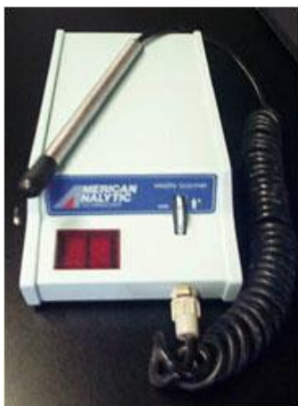
รูป 1-2 เครื่องวัดความมีชีวิตของฟันที่ใช้ภายในคลินิก
