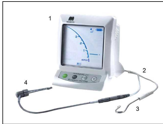
รูป 4-5 แสดงส่วนประกอบต่างๆของ Root ZX: (1) Root ZX (2) probe cord (3) contrary electrode หรือ lip clip (4) file holder
